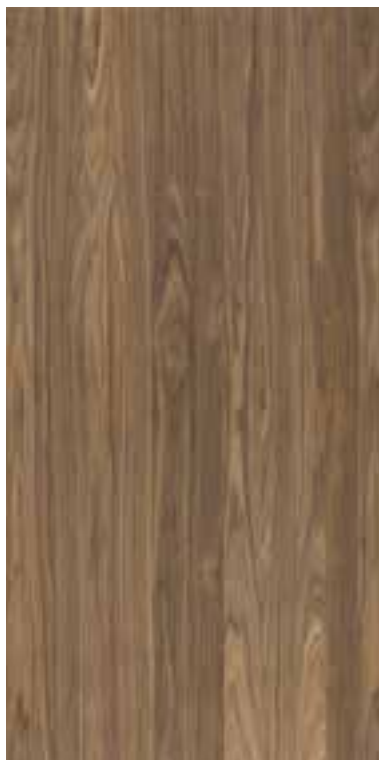
Voorbeeld: Houtsoort: Noten Amerikaans Snijwijze: DOSSE Voegwijze: MIXMATCH
